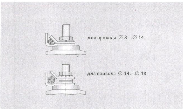
Рис. 16 Зажим провода Код заказа M11, вес 0,1 кг
